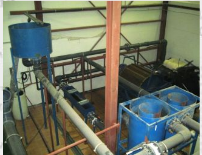
Камера гашения напора и песколовки
