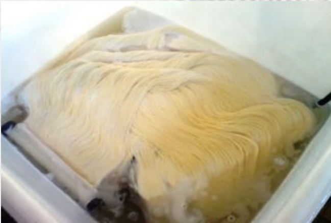
Подготовка мембран к монтажу
